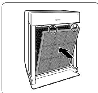
**③ Čelný kryt zariadenia nasadte späť tak, že najprv zasuňte do prístroja západky a potom pomaly zatvárajte kryt, kým sám vďaka magnetu nezostane držať.**
