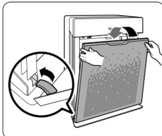
**④ Po výmene filtrov je potrebné resetovať kontrolku „Check filter“. Zapnite prístroj a po dobu 5 sekúnd podržte tenký predmet, ako napríklad svorku na papier, v otvore tlačidlá RESET.**
